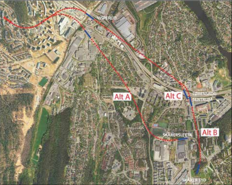
Trasèalternativene A, B og C for forlengelse av T-banen fra Ellingsrud til Lørenskog. Illustrasjon : Ruter/Norconsult (2019). Forslag til stasjoner i blått.
