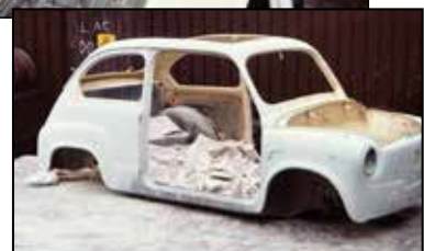
Bilen ferdig grunnet innvendig. Nå skal understilling monteres.
